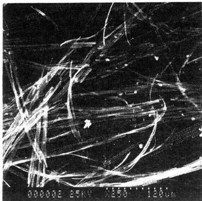
図9 ファイバー状シリカメソ構造体のSEM像
