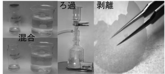
図1 ろ過を基盤とする粘土-有機化合物ハイブリッド膜の作製手順。① 混合, ② ろ過, ③ 剥離。
