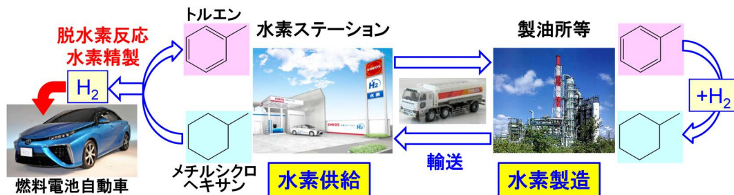
図1. トルエン／メチルシクロヘキサン系有機ハイドライドを用いた水素輸送システム。
