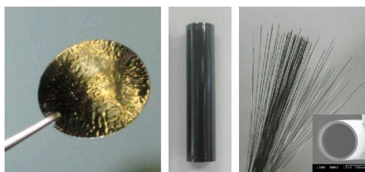
図2. 平膜（外径30 mm）、管状炭素膜（外径10 mm）と中空糸炭素膜（外径0.25 mm）。
