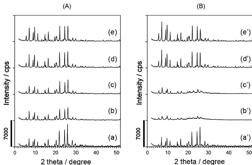
図6. 脱AI条件と骨格安定化の関係を示す粉末XRDパターン
