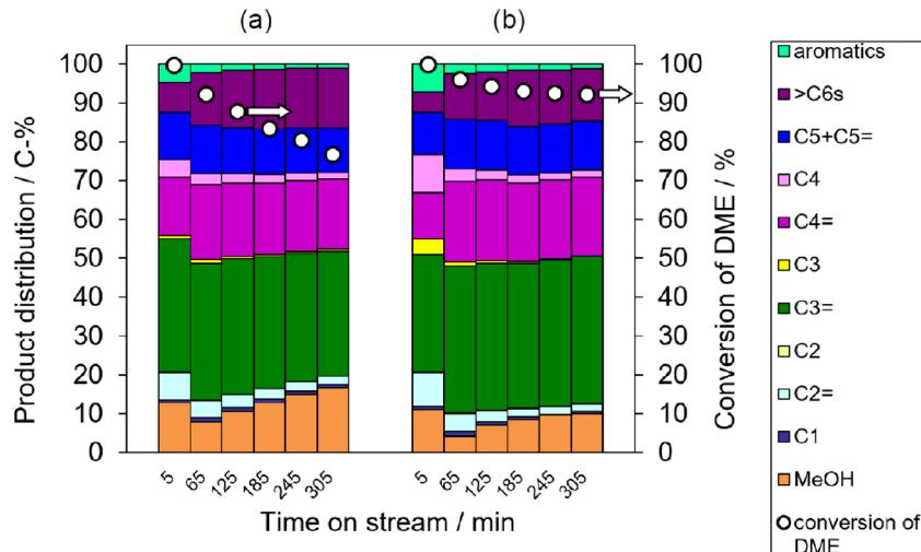
図10. (a) 安定化処理前, (b) 安定化処理後の触媒を用いたDTO反応
