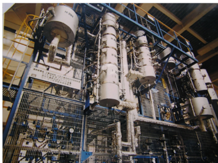
図2. ベンチ反応装置 (1 kg/day)
