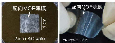
図 11. SiC 基板、プラスチック (セロファンテープ) 上に形成した \text{Cu}_2(\text{BDC})_2 MOF 配向薄膜
