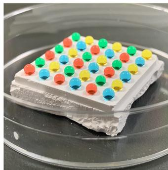
図5. メチルシルセスキオキサン複合多孔体で作製した撥水基板に液滴を並べた様子。培養液を用いることで立体細胞培養に用いられる<sup>17)</sup>。
