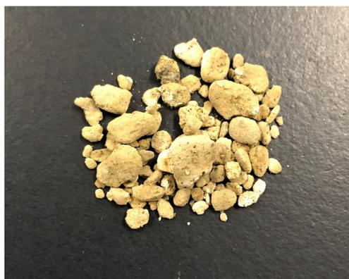
図4. 漂着軽石から作製した試料の外観写真。
